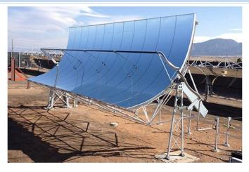
图: 做性能测试的 SkyTrough®DSP 模块
