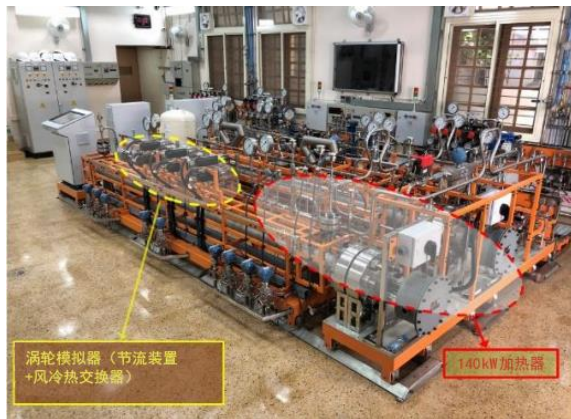
图 4 IISc 班加罗尔的简单回热 S- \text{CO}_2 布雷顿循环测试回路设施 [26]
