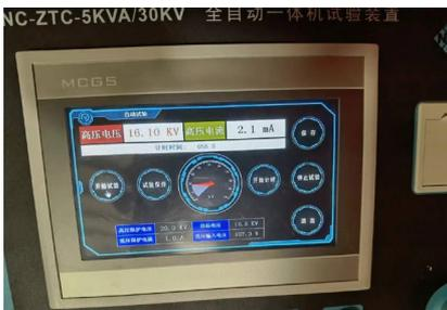
绝缘材料耐压测试
