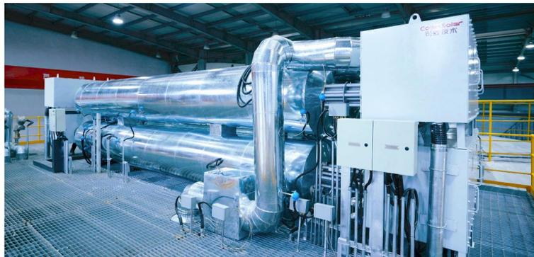
2MW6kV熔盐电加热器样机
