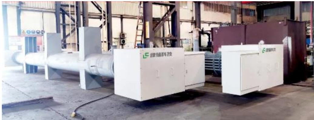
20MW6kV熔盐电加热器样机
