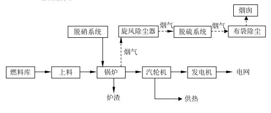
图 1 工艺流程图
